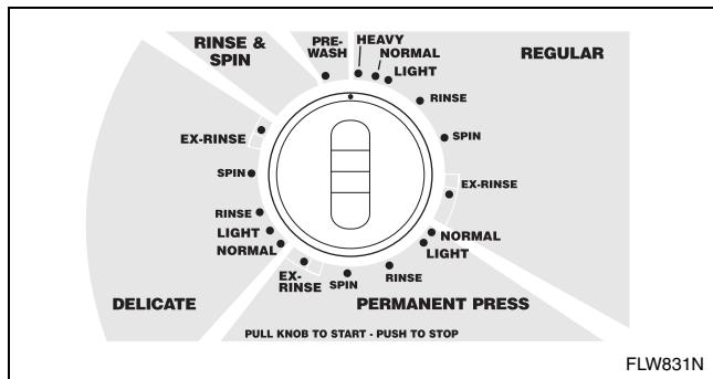
8. Tire del botón del temporizador para poner en marcha la lavadora. Al cabo de un breve período de espera, se iluminará la lámpara DOOR LOCKED (puerta con el pestillo echado), empezará a llenarse de agua el balde y se iniciará la agitación del tambor de lavado.
